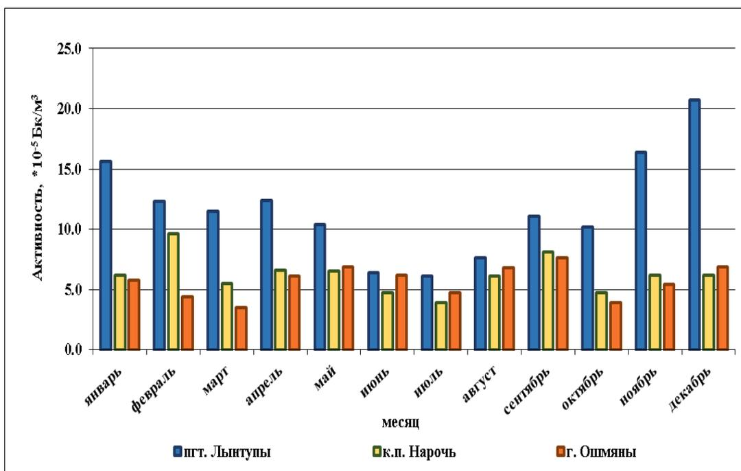
Рис. 5.4. Среднемесячные значения суммарной бета-активности в пробах аэрозолей на пунктах наблюдений в районе размещения Белорусской АЭС, 2023 год
