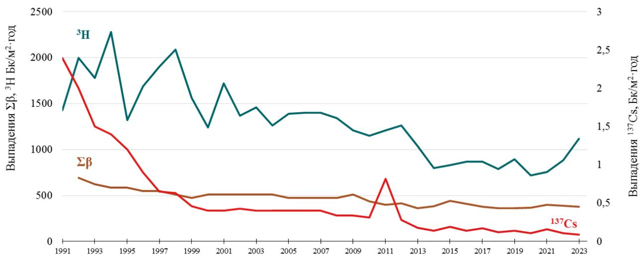
Рис. 1.11. Динамика выпадений радионуклидов на подстилающую поверхность и трития (с осадками) вне загрязнённых зон РФ в 1991–2023 гг.
