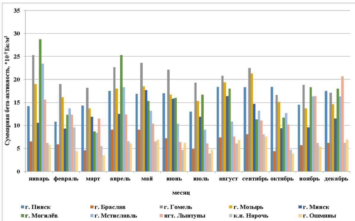
Рис. 5.1. Среднемесячные значения суммарной бета-активности в пробах аэрозолей на пунктах наблюдений за 2023 год
